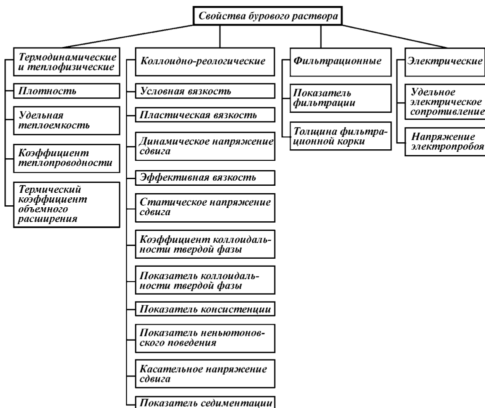
Рис. 7.1. Классификация основных свойств бурового раствора
