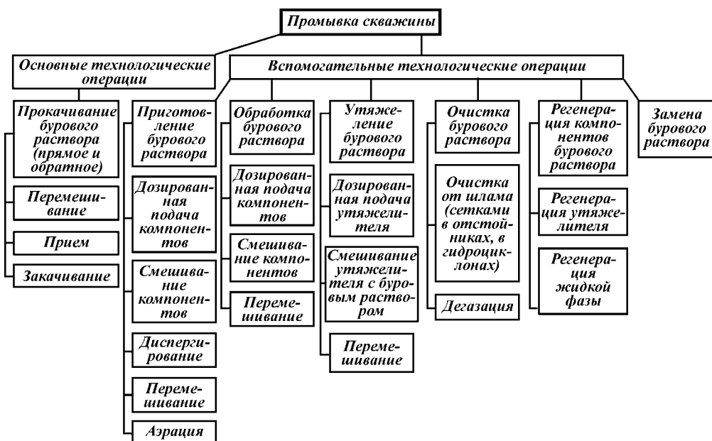
Рис. 7.2. Классификационная схема промывки скважин
