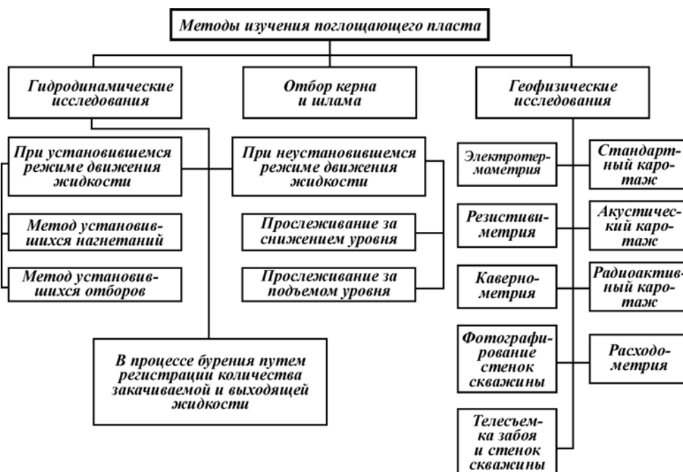
Рис. 8.1. Классификация методов изучения поглощающих пластов (по В.И. Крылову)
