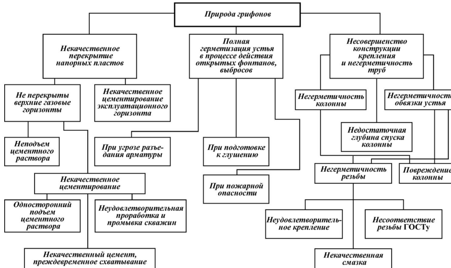
Рис. 8.10. Схема классификации причин возникновения грифонов по Н.А. Сидорову и Г.А. Ковтунову
