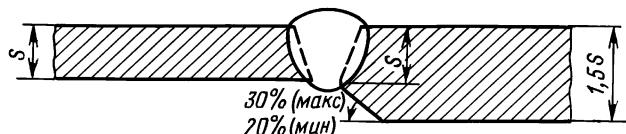
Рис. 3.2. Конструктивные размеры разделки кромок и сварных швов разнотолщинных труб (до 1,5 толщины стенки)
