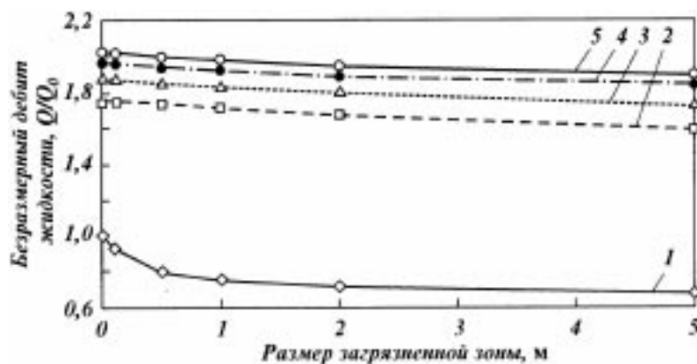
Рис. 3.6. Зависимость безразмерного дебита скважины после гидроразрыва от размеров загрязненной зоны при проницаемостях: пласта – 0,01 \text{ мкм}^2 , трещины – 50 \text{ мкм}^2 , загрязненной зоны – 0,005 \text{ мкм}^2 . Полудлина трещины l , м: 1 – 0, 2 – 10, 3 – 20, 4 – 50, 5 – 200
