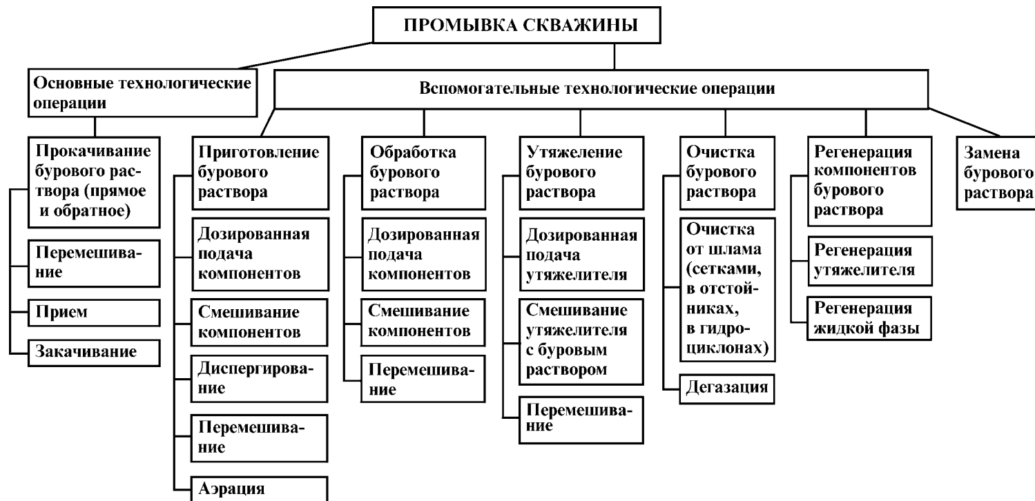
Рис. 6.2. Классификационная схема промывки скважины
