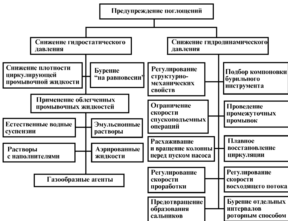
Рис. 7.2. Схема факторов, обуславливающих снижение гидростатического и гидродинамического давлений на стенки скважины
