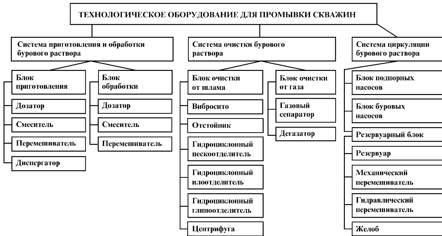
Рис. 6.3. Классификационная схема технологического оборудования для промывки скважины
