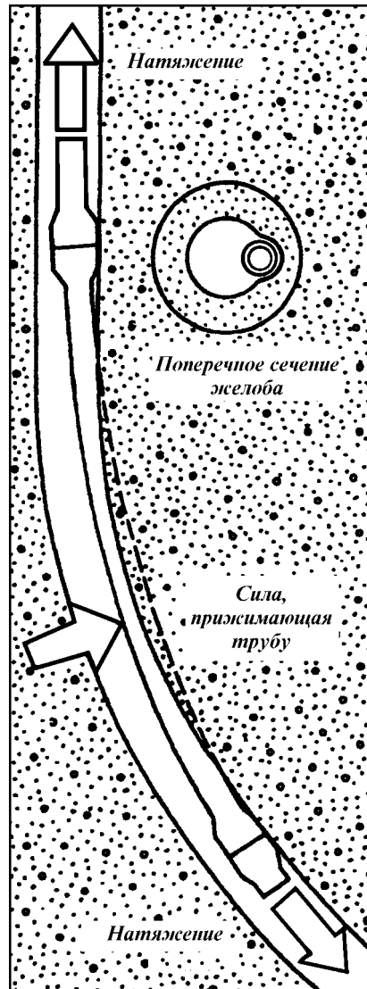
Рис. 9.12. Схема образования желоба в виде замочной скважины
